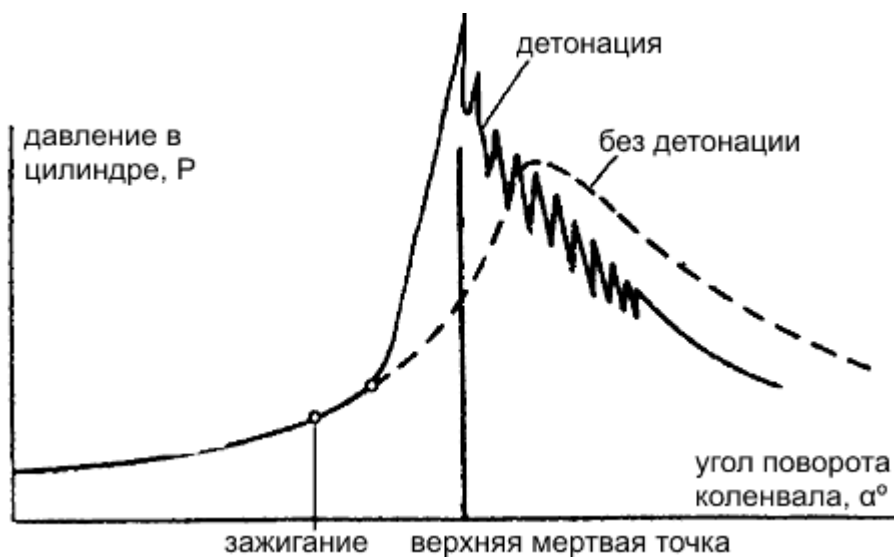
Рисунок №8. Давление в цилиндре при нормальном и детонационном сгорании
